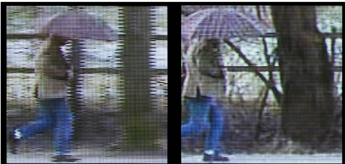
Figur 1: Udsnit af et "interlaced" og et progressivt billede
